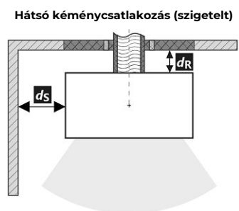
A füstcső áthaladása éghető anyagból készült falon
