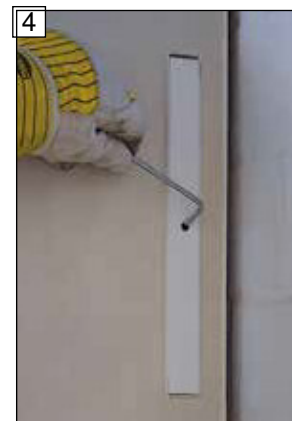
4 Na vytažení ochranné svorky z montážní skříňky používejte otvor, který je na to určený.
