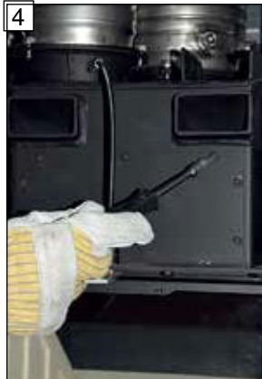
4 Odstraňte upevňovací šroub na revizním uzávěru.
